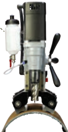
Contenitore per lubrifi ante con protezione per eccessiva pressione
