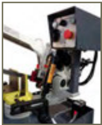
Pannello di controllo con selettore di discesa manuale o controllata
