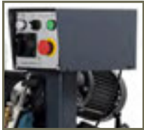
Pannello di controllo con selettore di discesa manuale o controllata
