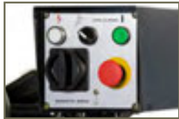
Pannello di controllo con selettore di discesa manuale o controllata
